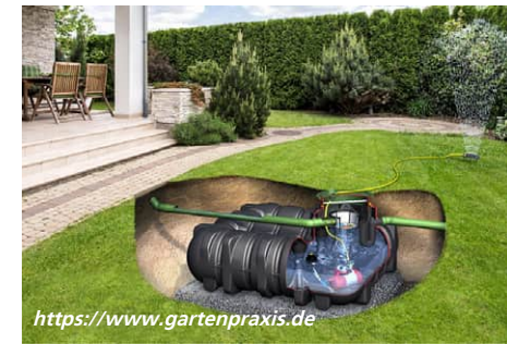
Unterirdische Zisternen als Regenwasserspeicher
